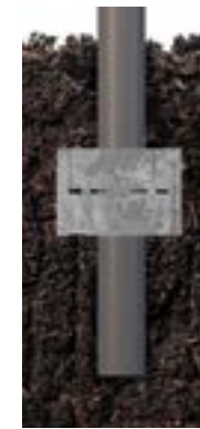
Posadowienie z dodatkowym akcesorium usztywniającym - płytą ustojową
