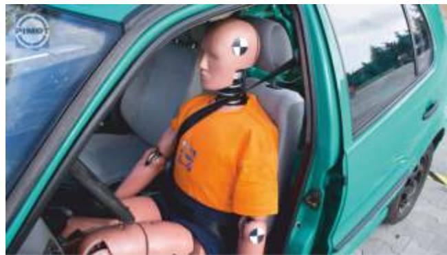
Während der Fahrzeugkollision mit dem Mast wurde die Sicherheitszone des Fahrers in der Kabine nicht berührt.
