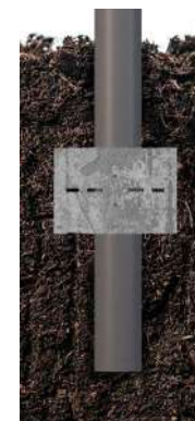
Posadowienie z dodatkowym akcesorium usztywniającym - płytą ustojową
